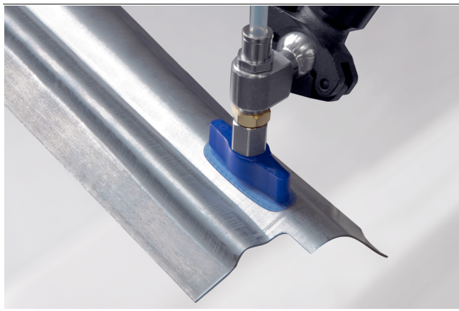
Ventosa tipo campana SAOXM durante la manipulación de formatos de chapa
